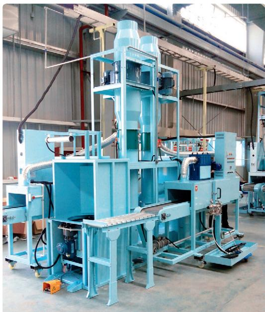
**用途：小型零部件从喷涂到干燥的流水线作业设备。**
